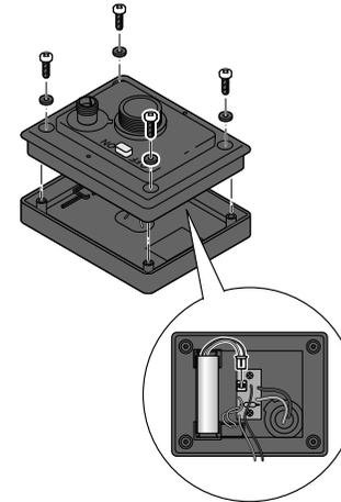
3. Desserrez les vis sur la face inférieure du module solaire avec un tournevis cruciforme et retirez le cache. Faites attention à ne pas arracher de câbles!
