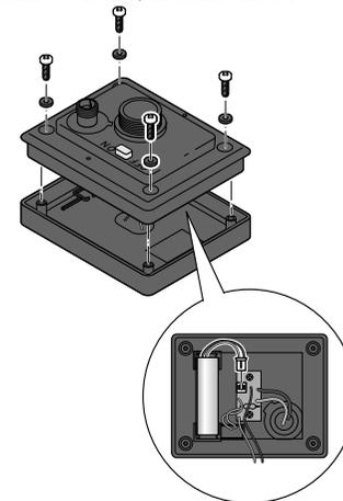
3. Lösen Sie die Schrauben auf der Unterseite des Solarmoduls mit einem Kreuzschlitzschraubendreher und nehmen Sie die Abdeckung ab. Achten Sie dabei darauf, keine Kabel abzureißen!
