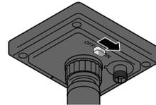
▷ Poussez l'interrupteur situé sur la face inférieure du module solaire sur **ON** pour activer la guirlande lumineuse. Il s'agit de la position standard dans laquelle la guirlande lumineuse fonctionne de manière entièrement automatique:
