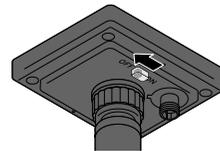
▷ Si vous souhaitez désactiver la guirlande lumineuse, poussez l'interrupteur situé sur la face inférieure du module solaire sur **OFF**. La guirlande lumineuse est alors éteinte en permanence. La batterie continue à se recharger dès que la luminosité est suffisante.
